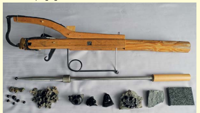
Mit Zange oder Kluppe und „Schnapperer“ wurden Glasknöpfe hergestellt. Aus dem Gestein Proterobas wurden schwarze Glasknöpfe gefertigt. Als Abfallprodukt aus Verbrennungsrückständen im Brennofen fällt dabei Glasschlacke an.
