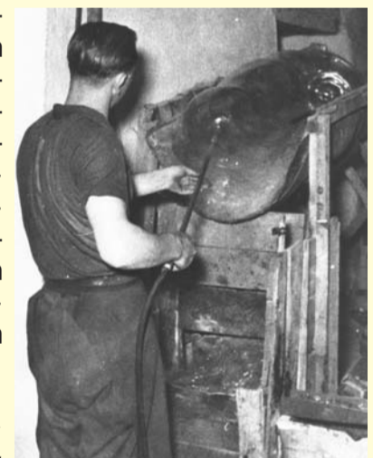
Blasen eines großen Hohlkörpers mit der Glaspeife zur Gewinnung von Glasstaub.
