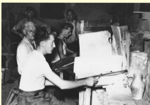
Perlenmacher bei der Arbeit in der Hütte. Vorne werden die Perlen vom Perleneisen vorsichtig abgeklopft.
